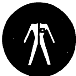
Задължително използване на защитен комбинезон
